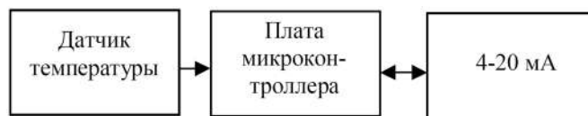
Рисунок 5 - Структурная схема преобразователя
